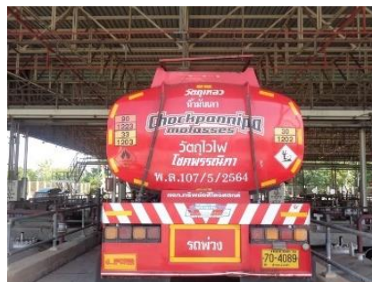
รูปที่ 2.2-18 (ต่อ) ป้ายสะท้อนแสงที่รถขนส่งน้ำมันเตา
